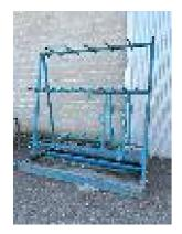
1 A-FRAME RACK, HEAVY DUTY STEEL FREE STANDING, DOUBLE SIDED 2400 x 1440 x 2420mm (H)
