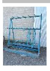
1 A-FRAME RACK, HEAVY DUTY STEEL FREE STANDING, DOUBLE SIDED 2400 x 1440 x 2420mm (H)
